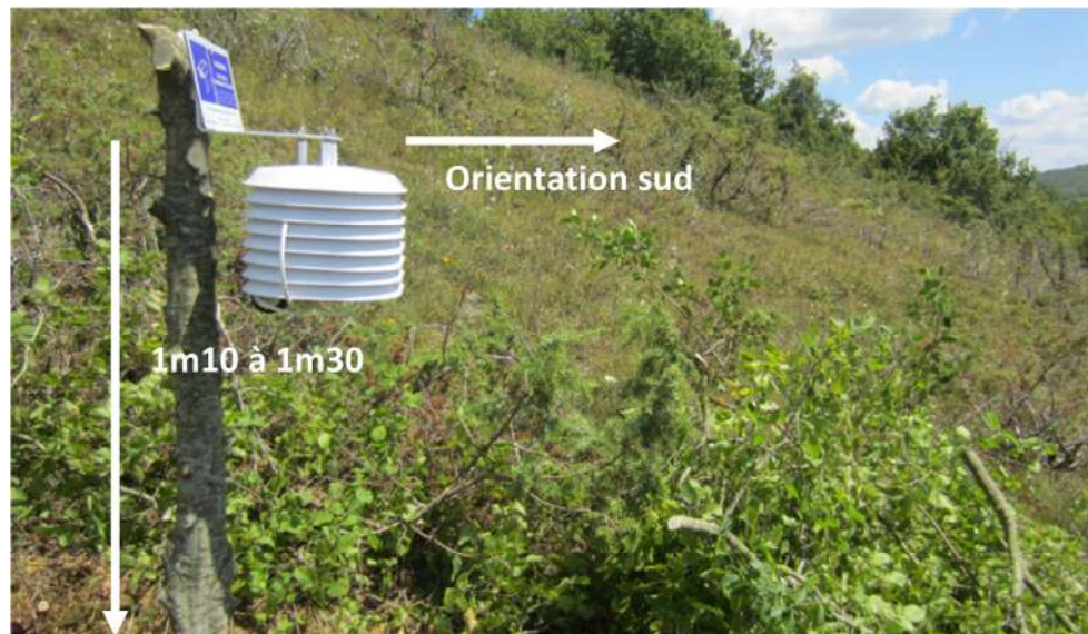
Figure 3 : Station météorologique sur un site d'étude du programme Les sentinelles du climat Nouvelle Aquitaine en pelouse calcicole.
