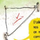
D'ailleurs, pour être sûr que nos carrés sont bien carrés, on mesure la diagonale et on corrige un côté si besoin.
